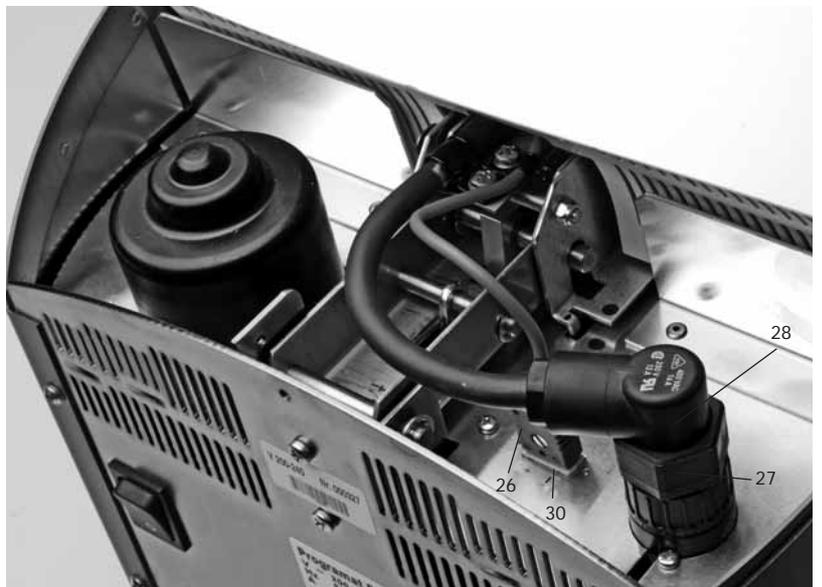
Fije la conexión de la mufla (28) con el seguro de conexión (27) girando hasta que la conexión de la mufla (28) esté asegurada.
