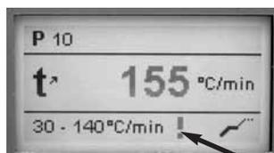
Como mensaje de error (error de introducción: introducción fuera del rango de valores) parpadea un símbolo de exclamación en la parte inferior de la pantalla hasta la introducción de un nuevo valor y confirmación
