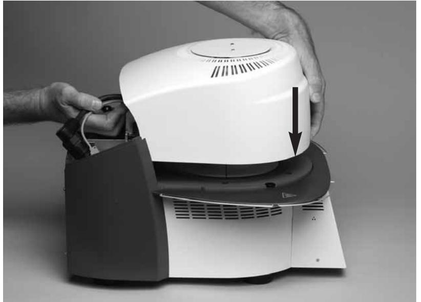
Compruebe que la muesca de montaje del cabezal (41) coincide con la muesca de la parte inferior del horno (42).
