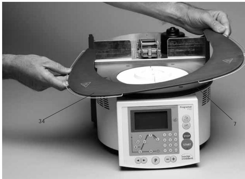
Seguidamente asegure la plataforma de apoyo (34) con los dos tornillos de fijación (35) incluido el apoyo de silicona (47)
