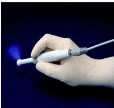
Lámpara LED para la fotopolimerización de resinas
